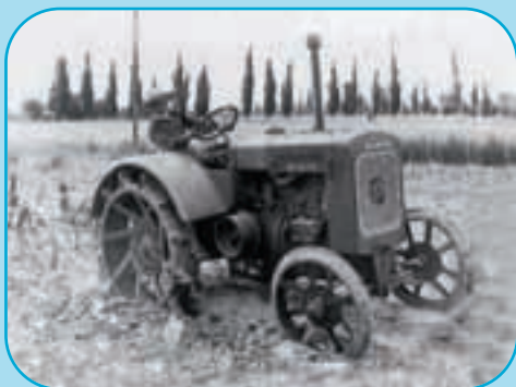
28-PS-Deutz-2-Zylinder, wassergekühlt, um 1930, Foto: Deutsches Traktoren- und Modellautomuseum
