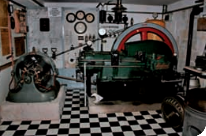
Herford-Motor treibt einen Generator von 1910 an, Foto: LWL-Industriemuseum
